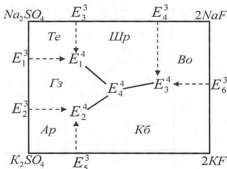
Расм. Сохтори диаграммаи мувозинатҳои фазагии системаи  $\text{Na,K//SO}_4\text{-F-H}_2\text{O} - \text{H}_2\text{O}$  дар ҳарорати  $50^\circ\text{C}$ , ки бо усули транслятсия сохта шудааст
