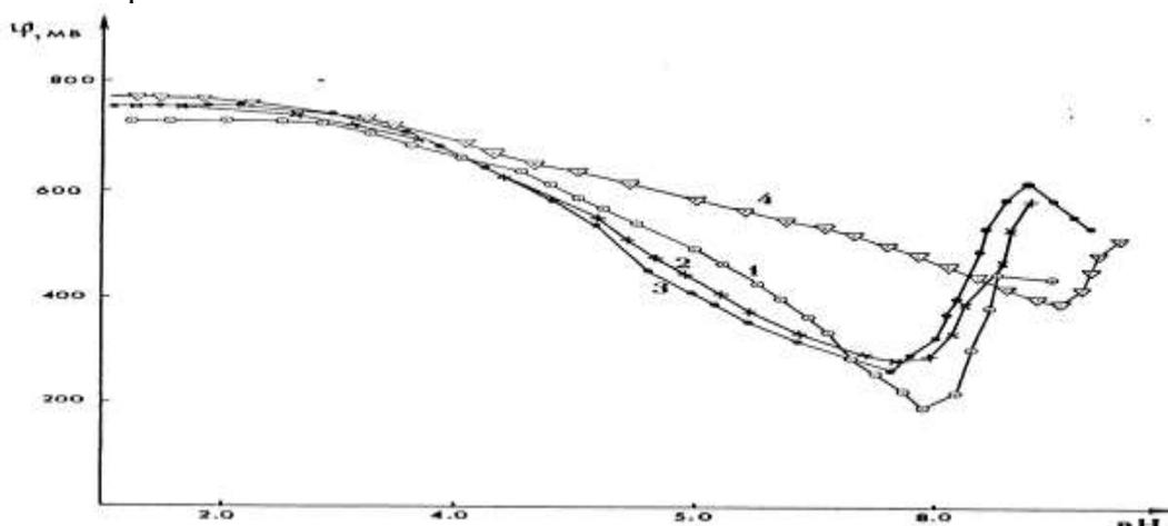
Рис.1. Зависимость окислительного потенциала ( $\phi$ ) от pH раствора при  $C_{\text{Fe}^{2+}} = C_{\text{Fe}^{3+}} = 110^{-4}$  М,  $J = 1,0$  М,  $T = 308$  К
