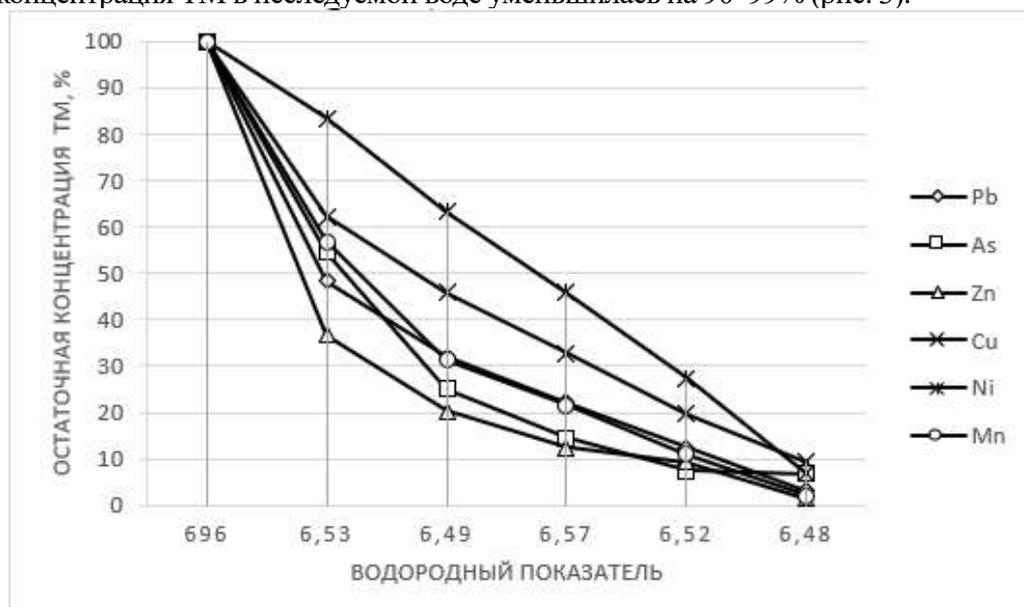
Рис. 3. Зависимости остаточной концентрации ТМ от значения рН среды при дозе хлорида железа 200 мг/л.
