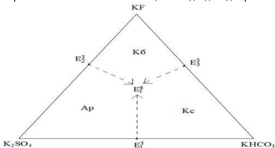
Рис. 2. Схематическая диаграмма фазовых равновесий системы  $K_2SO_4$ - $KHCO_3$ - $KF$ - $H_2O$  при  $0^\circ C$ , построенная методом трансляции
