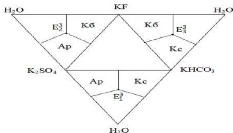
Рис. 1. Диаграмма фазовых равновесий системы  $K_2SO_4-KHCO_3-KF-H_2O$  при  $0^\circ C$  на уровне трёхкомпонентного состава
