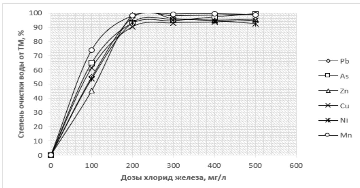
Рис. 2. Зависимости степени очистки воды от дозы коагулянта при его дозах в интервале от 100 до 500 мг/л.
