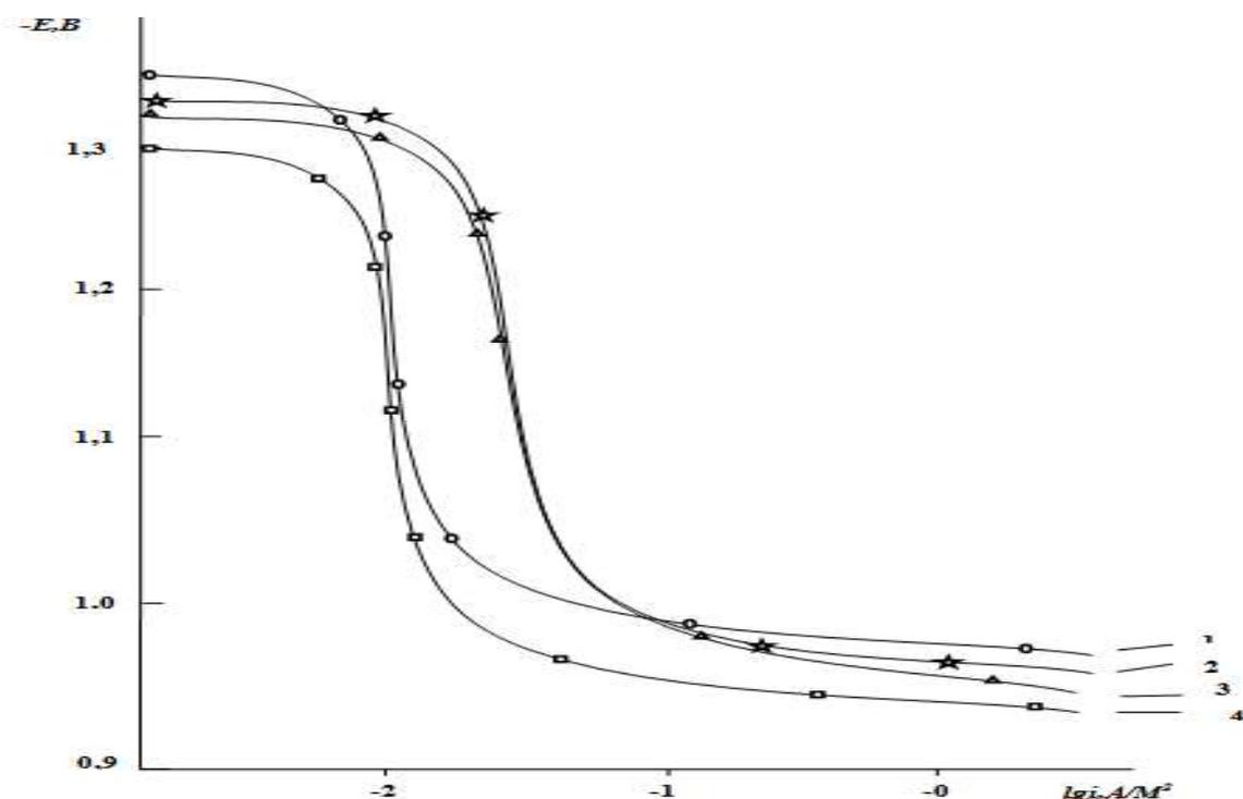
**Рис.** Потенциодинамические анодные поляризационные кривые (2мВ/с) цинкового сплава ЦАМг4,5-2(1), содержащего скандий, мас.%.: 0.01(2),0.05(3), 0.1(4), в среде электролита 3%-ного NaCl
