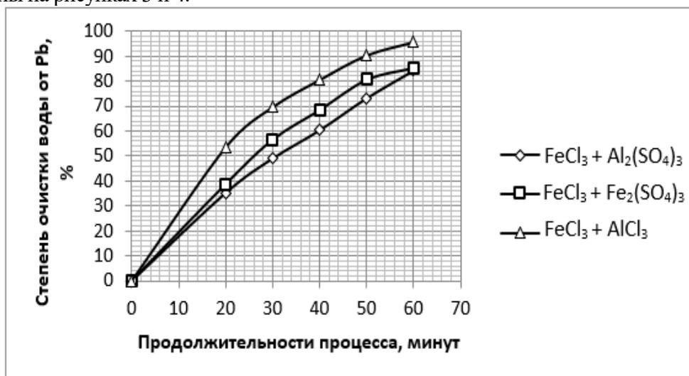
Рис. 3. Зависимости степени очистки воды от продолжительности процесса.
