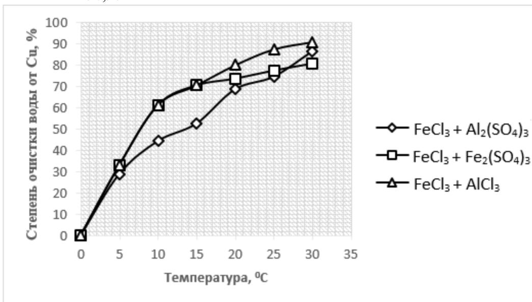
Рис. 2. Зависимости степени очистки воды от температуры.
