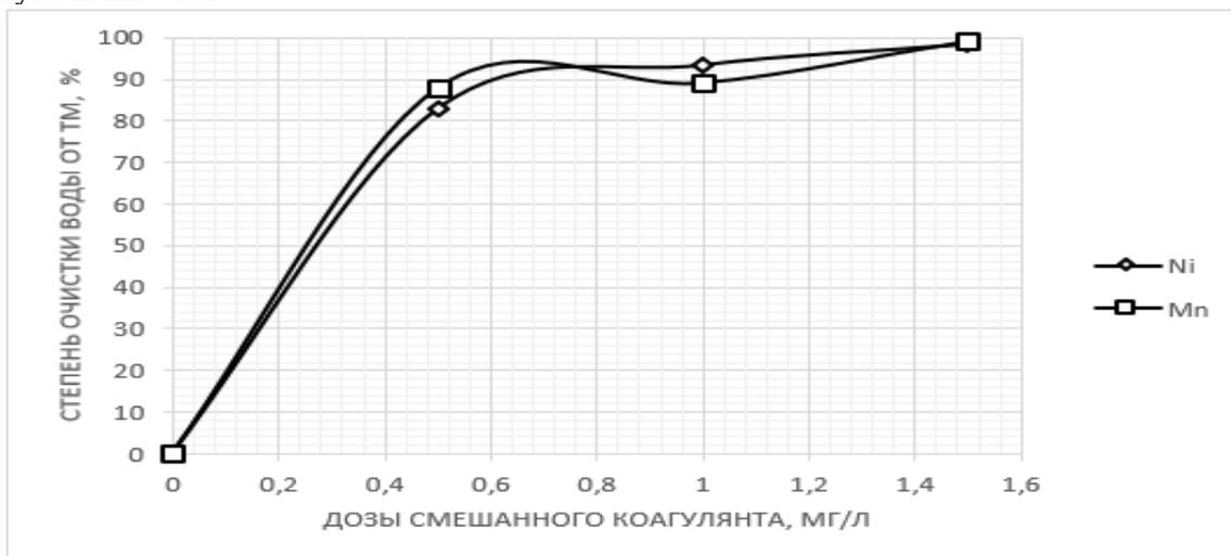
Рис. 1. Зависимости степени очистки воды от дозы смешанного коагулянта.
