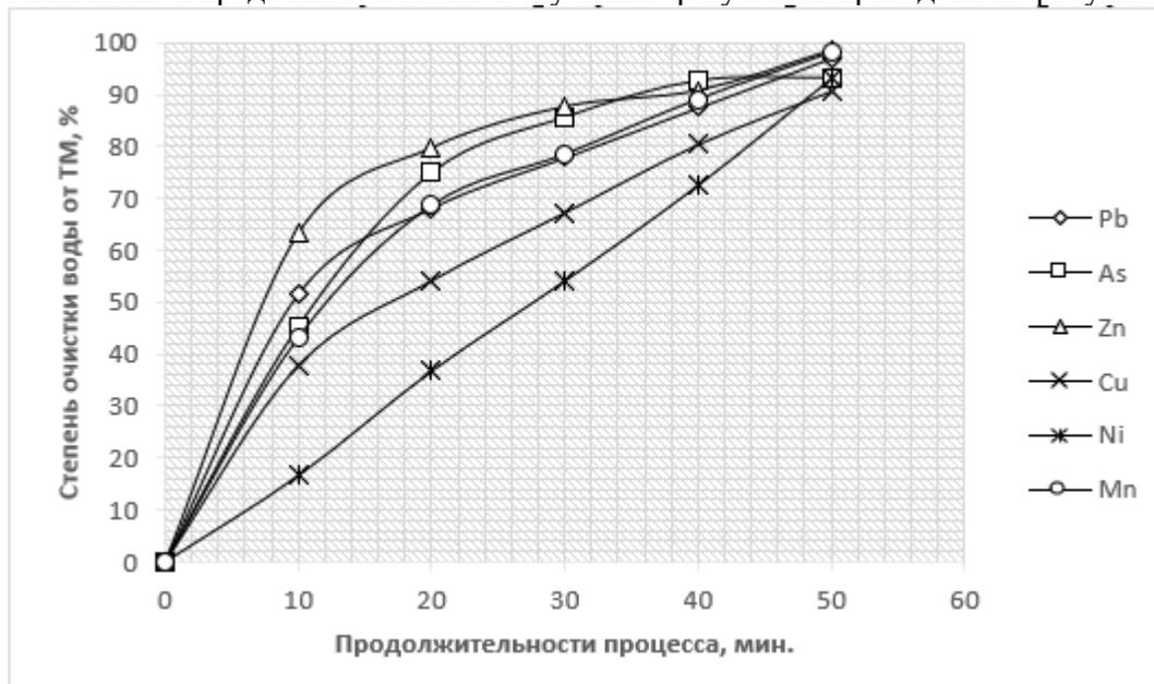
Рис. 1. Зависимость степени очистки воды от продолжительности процесса коагуляции в интервале от 10 до 50 мин.
