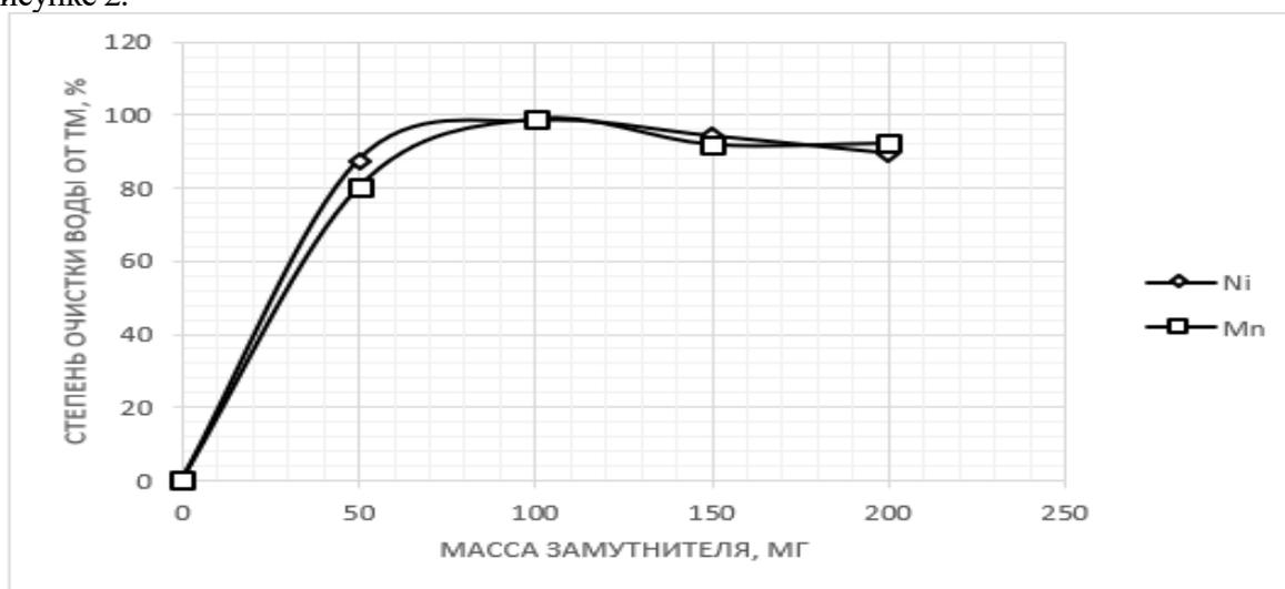
Рис. 2. Зависимости степени очистки воды от массы замутнителя.
