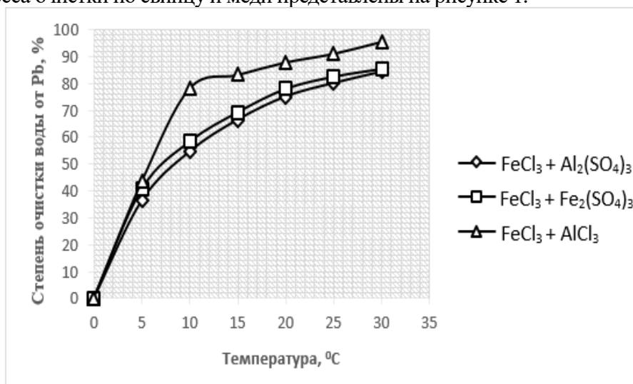
Рис. 1. Зависимости степени очистки воды от температуры.
