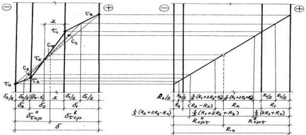
Рис. 2. Схема, представленная к определению величины  $R_{cp,\tau}^6$  для трехслойной стеновых ограждений.
