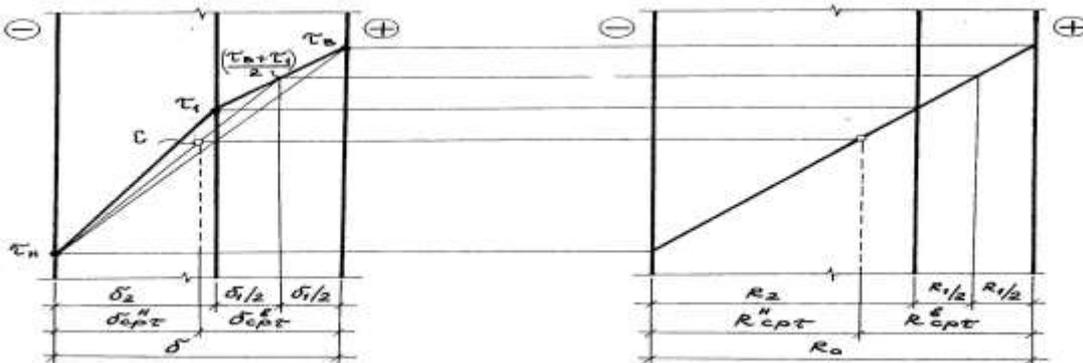
Рис. 1. Схема, представленная к определению величины  $R_{ср,τ}^6$  двухслойной стеновой ограждений.
